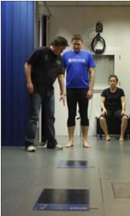
Hochauflösende Sensormatten zeigen die Druckverteilung unter dem Fuß.
